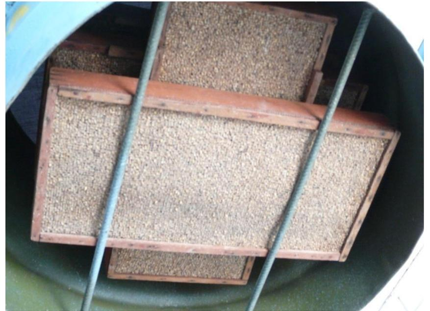
**Los bastidores con el trigo se colocan dentro del cilindro en forma transversal uno con respecto al otro**
