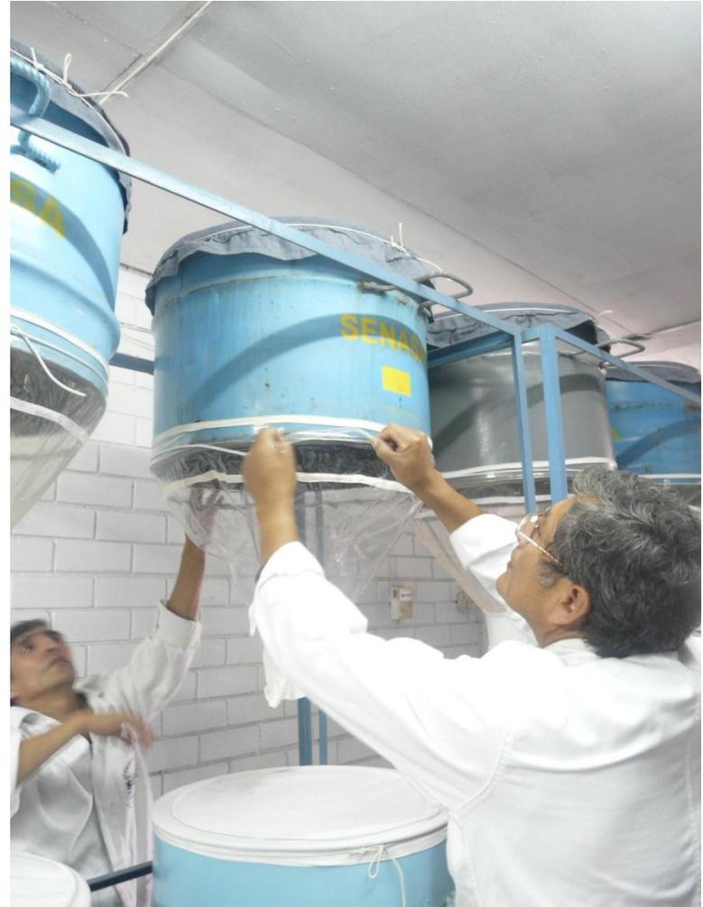
**Se coloca una tapa de tela en la parte superior y el embudo de plástico en la parte inferior.**
