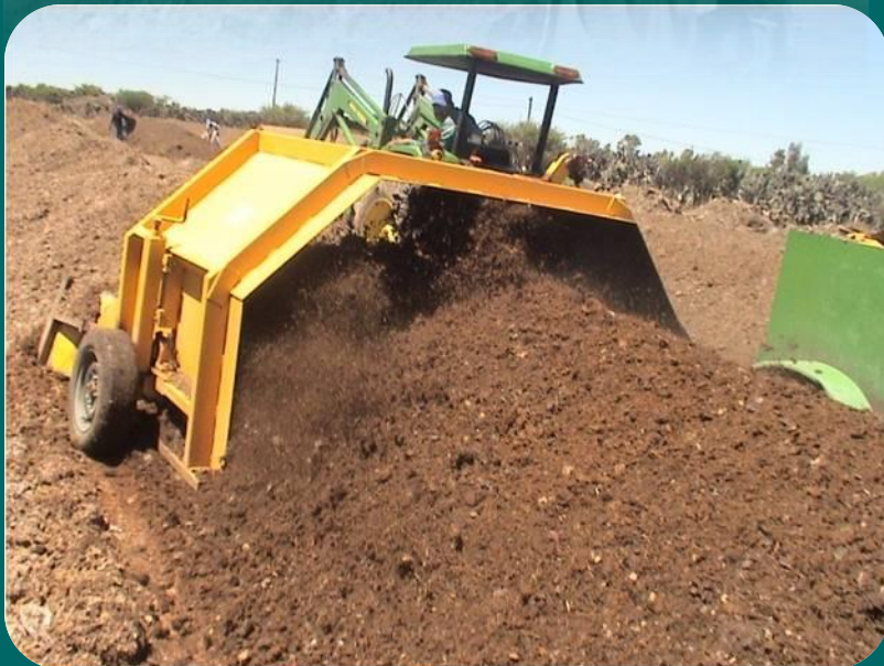
Aireación y control de T^{\circ}C de pilas
